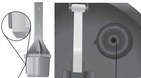
Onglet Entaille et orifice du filtre
